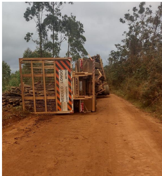
Figura: 9- Tombamento resultante do fenômeno da amplificação traseira
