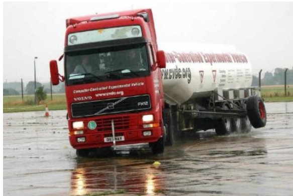
Figura 15: Ensaio para determinação de parâmetros de estabilidade
