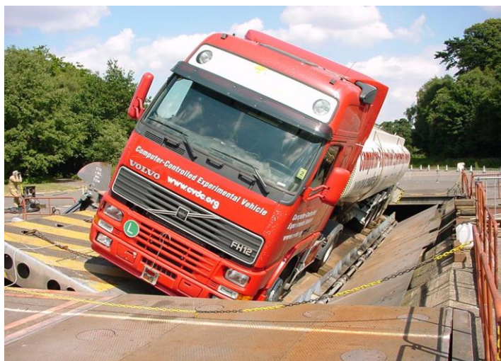
Figura 16. Plataforma " Tilt Table ", ensaio para verificação de SRT
